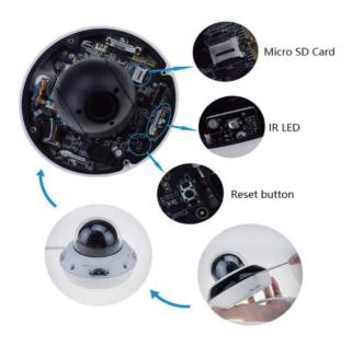
Micro-SD-Karte: Unterstützt das Einsetzen einer Micro-SD-Karte mit bis zu 256 G. Reset-Taste: Setzt die Einstellung der Kamera auf die Standardeinstellungen zurück. IR-LED: Die IR-LED leuchtet auf, wenn die Umgebung dunkel genug ist.
